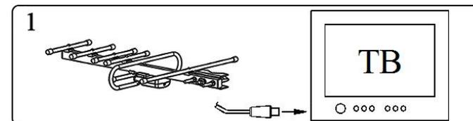
При использовании цифровой антенны модели L025.07D необходимо подключить ее к антенному входу телевизора (см. схему 1) или цифровой приставки (см. схему 3) и включить подачу питания +5В на цифровую антенну от телевизора или цифровой приставки. Подача питания +5В включается согласно инструкции по эксплуатации телевизора или приставки DVB-T2.
