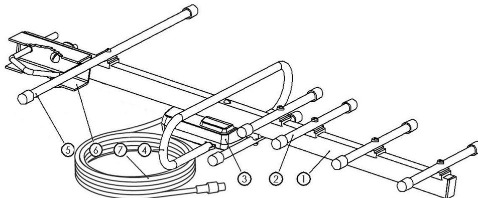
Антенна представляет собой несущую штангу (1), на которой закреплены директоры (2), монтажная коробка (3), с петлевым вибратором (4) (установку производит потребитель см. п.5), усилитель или плата согласования с вмонтированным кабелем (7), рефлектор (5). Для установки на мачту антенна имеет узел крепления (6).
